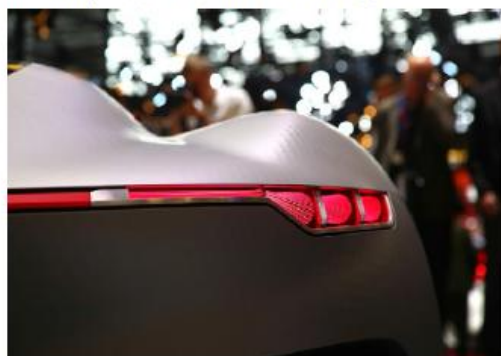
图 7 雷诺的 Trezor 概念车采用标志性的 C 形后部照明采用红色激光照明加光纤的方式，创造了一种有趣的视觉效果。来源：Motortrend
